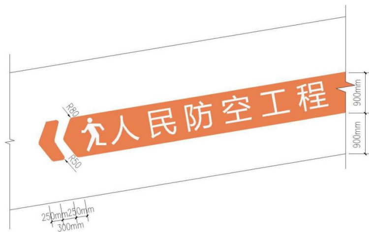
图 3 非机动车坡道侧墙标识样式示例
